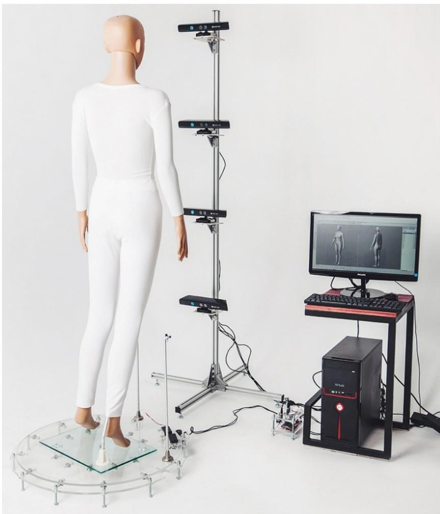
Рис. 5. Внешний вид разработанного 3Д сканера фигуры человека
