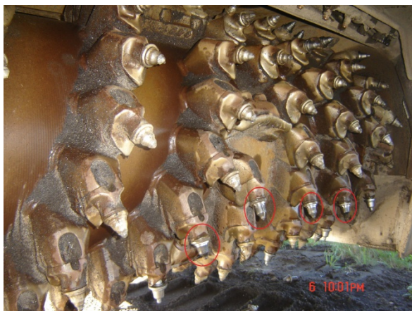
Рис. 3 – Барабан дорожной фрезы с установленными, опытными резцами
