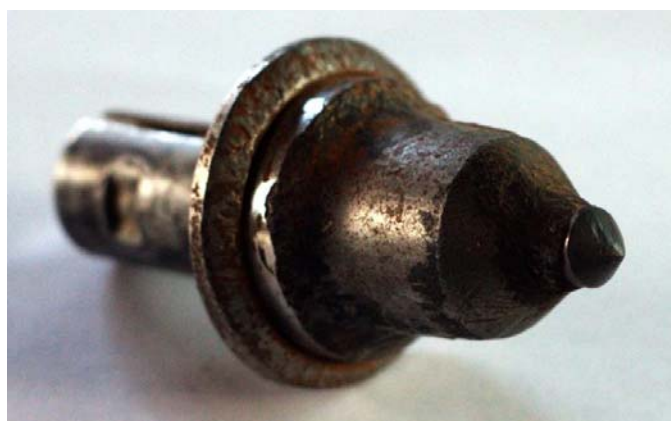
Рис. 5 – Опытный резец после проведения испытаний
