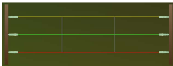
Рис. 2. – Расчетная схема пролета с двумя междуфазными распорками
