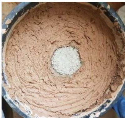
Рис. 1 – Армодрирующий элемент в грунте
