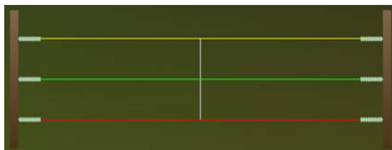
Рис. 1 – Расчетная схема пролета с одной междуфазной распоркой
