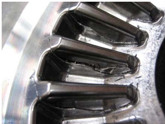
Рис. 8 – Вид разрушения формообразующих зубьев матрицы
