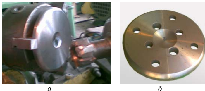
Рис. 3. Схема обработки сферической поверхности детали «Подпятник» (а) и вид «Подпятника» (б)
