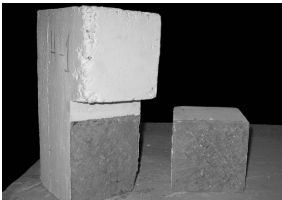
Рис. 1. Общий вид разрушения опытного образца
