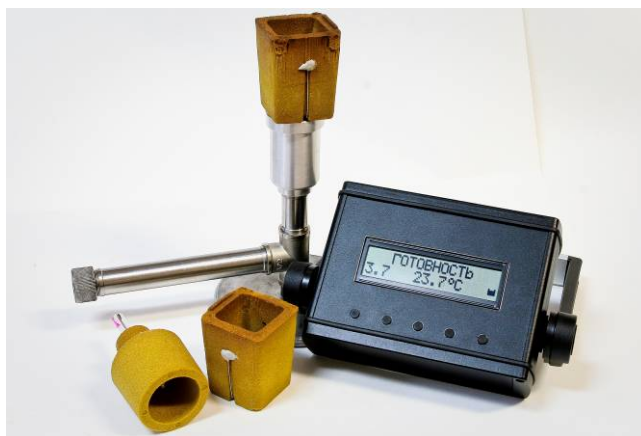
Рис. 1. Внешний вид портативной микропроцессорной системы термического экспресс-анализа литейных сплавов
