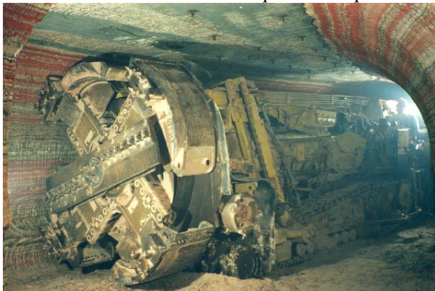
Рис. 2. Проходческий комбайн ПК-8МА
